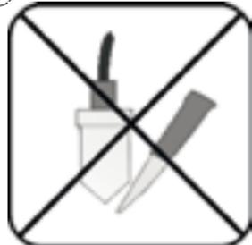
Sensoren vor Schmutz und Salzkrusten schützen, deshalb regelmäßig schonend reinigen, kratzen beschädigt den Sensor (5).
