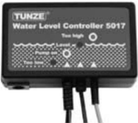
**Störung:** Rote LED „Too high“ leuchtet, erlischt und gelbe LED “Pump on“ leuchtet. Der Warnton ertönt, falls eingeschaltet.
