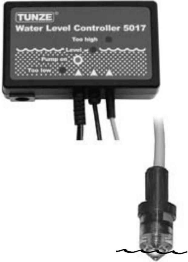
**Störung:** Gelbe LED „Pump on“ leuchtet und die Dosierpumpe läuft vermindert oder überhaupt nicht. Es kommt zu wenig oder überhaupt kein Wasser. Nach ca. 10 Minuten erlischt gelbe LED und rote LED „too low“ leuchtet.
